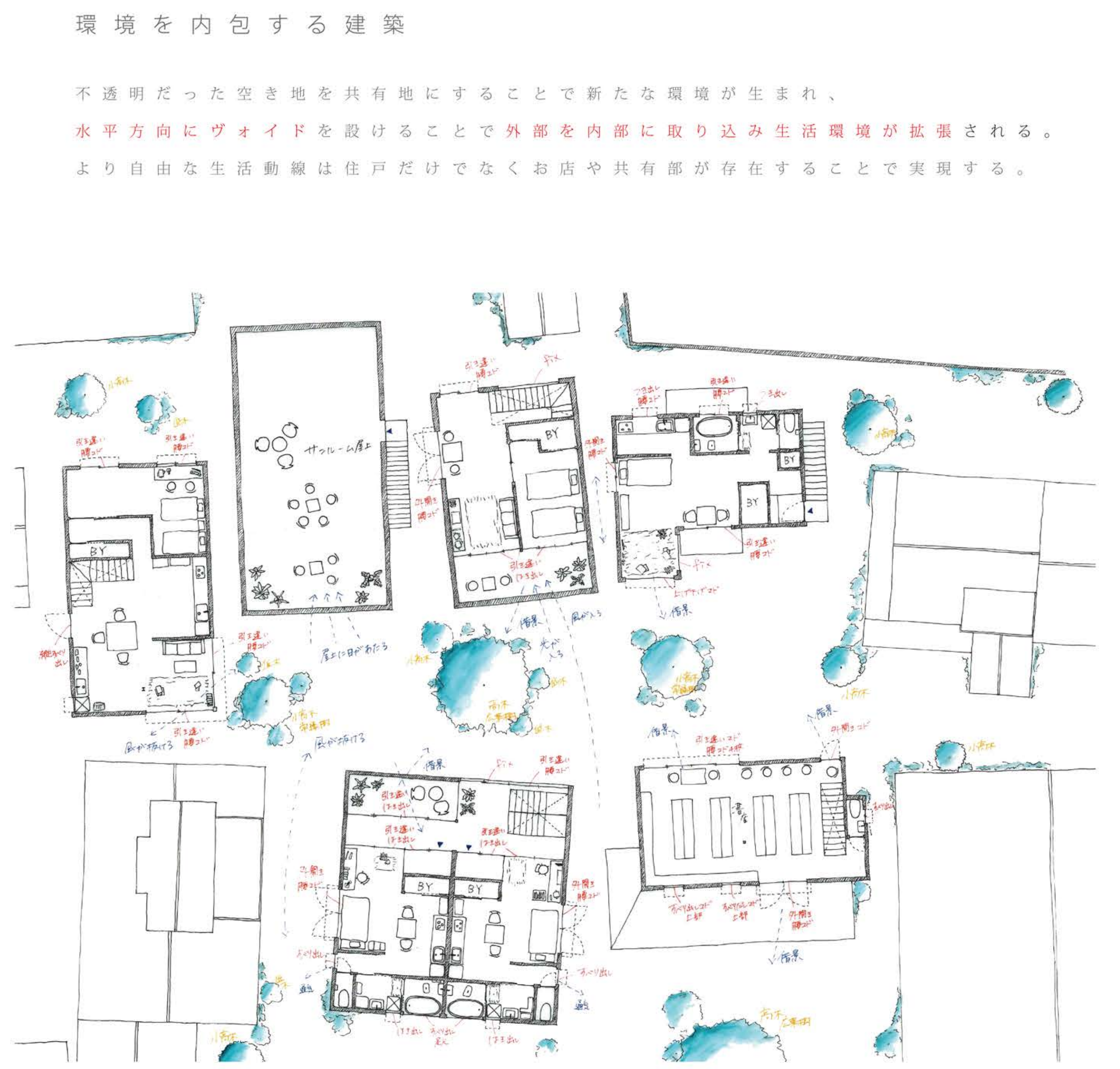
空き地、空き家、既存建築の開口を元に共有環境を構成した平面図 2F スケール 1/150
